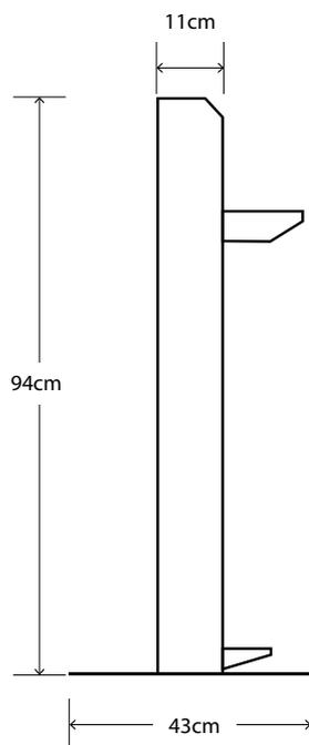
Le distributeur de gel hydro alcoolique permet une distribution automatique de doses de gel sans contact grâce à sa pédale située à l'embase.
